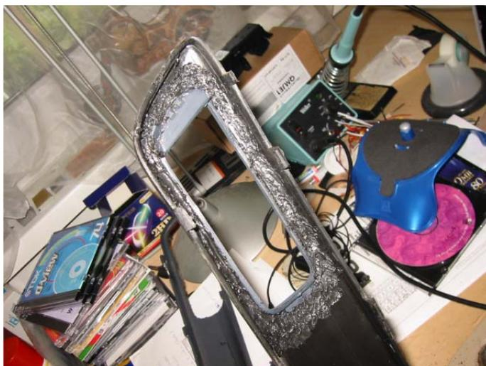
7. Dann wird auf der Oberseite , falls notwendig , mit etwas Material aufgefuellt ( auch hier einfach mit dem Loetkolben drueberschmieren ) :
