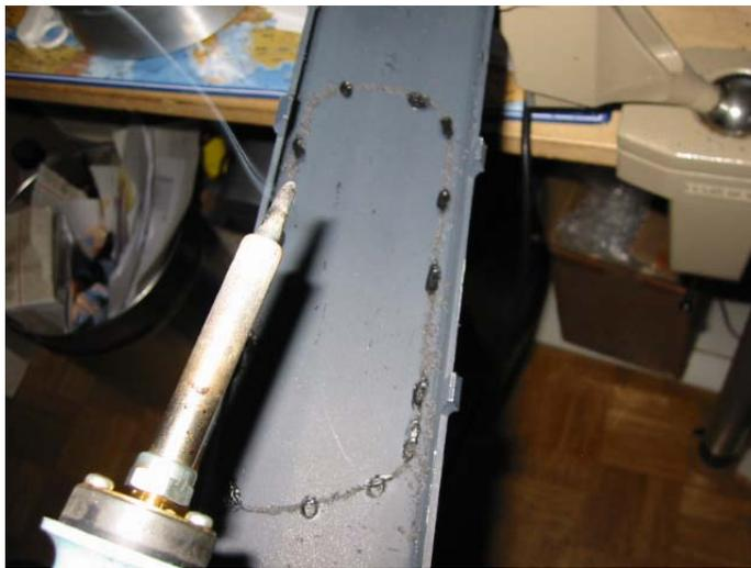
6. Jetzt wird der ganze Rahmen ringsum verschweisst ( nicht mit Material sparen , sonst reisst der Sch.... nachher wieder ) :
