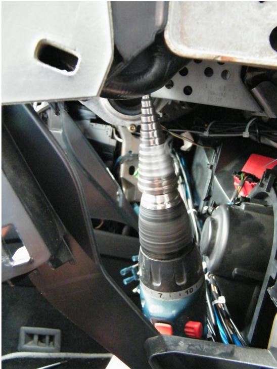
Zuerst bohrt ihr mit einem kleinen Bohrer in der Mitte der Markierung vor, danach kann mit einem Stufenbohrer das Loch so weit aufgebohrt werden, bis sich der Schlauch einklipsen lässt. Wir haben zuerst die Dicke des Schlauches am Ende zwischen den beiden Kragen gemessen und am Stufenbohrer eine Markierung gemacht. Wenn die Bohrung fertig ist, kann diese entgratet werden.
