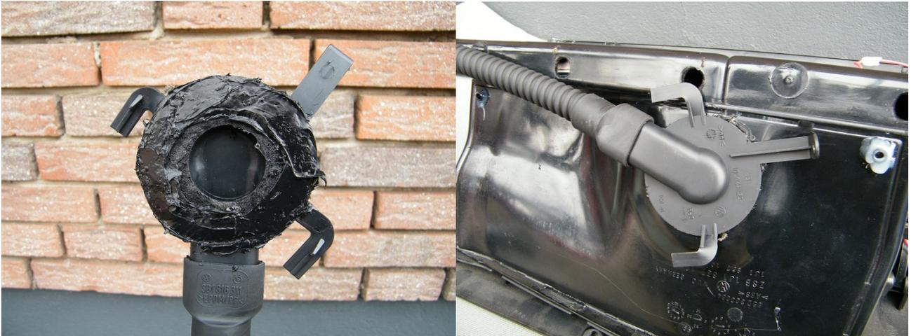
Das ist der Punkt, an dem etwas improvisiert werden muss. Da für die original vorgesehenen Halter keine Möglichkeit vorhanden ist, diese am Handschuhfach zu befestigen, muss geklebt werden.
