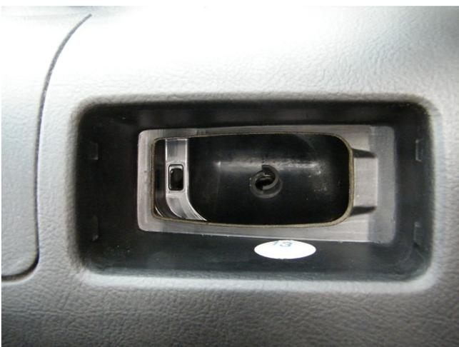
Nun kann das Handschuhfach wieder eingebaut und komplett befestigt werden. Der Schlauch, kann nun in das gebohrte Loch eingeklipst werden und die Lüftungsdüse wieder ins Armaturenbrett gesteckt werden.
