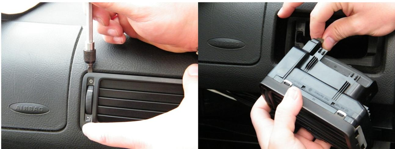
Mit einem Schraubendreher kann die Lüftungsdüse vorsichtig raus gehobelt werden.
