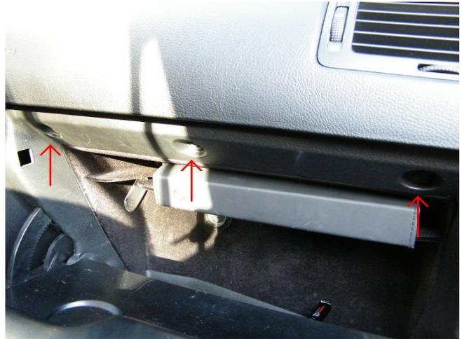
Danach die jeweils 3 Schrauben, unterhalb und oben im Handschuhfach raus drehen. Jetzt kann man anfangen, es vorsichtig raus ziehen, die Klipse an der Mittelkonsole lösen sich durch leichtes hinund herwackeln.
