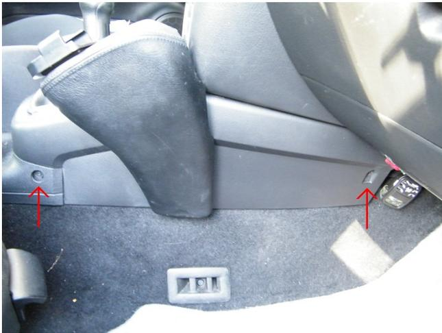
Also zuerst die beiden Schrauben an der Seite raus drehen, das selbe auf der Fahrerseite wiederholen. Die beiden unterhalb des Schaltkaufs sitzen normalerweise hinter einer kleinen Abdeckkappe.
