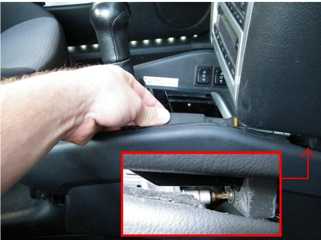
Als erstes die Schraube unterhalb der OBD- Blende lösen. Diese Halterung ist bei manchen schon nicht mehr vorhanden, da diese des öfteren einfach abgerissen wird, um sich entweder das Lösen der Mittelkonsole zu sparen oder, einfach aus Unwissenheit ;-)
