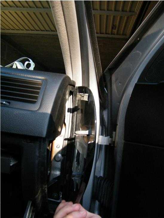
Das Handschuhfach öffnen und vorsichtig hinter die Abdeckung greifen und diese nach rechts abziehen.
