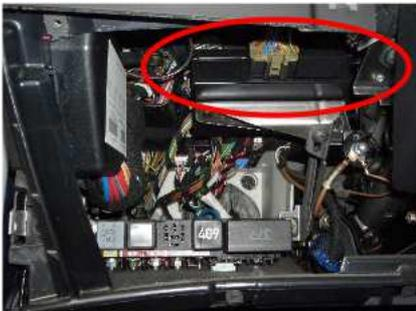
Ja hier ist nun das eingebaute Steuergerät zusehen. Wie man dieses nun ausbaut wird in Schritt 8 beschrieben.
