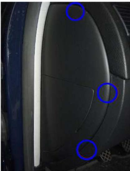
Wir beginnen mit der Demontage einiger Verkleidungen. An den markierten Stellen mit einem kleinen Schraubenzieher zwischen die Verkleidungen gehen und vorsichtig raushebeln. Das Ergebnis sollte so wie auf dem Bild in Schritt 2 aussehen.
