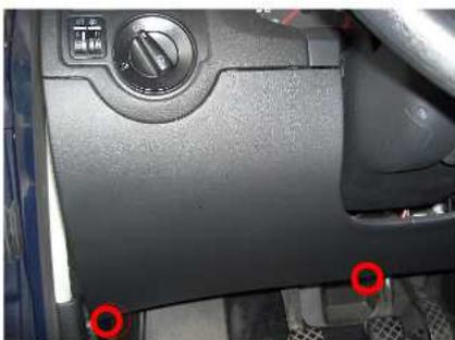
An den markierten Stellen muss nun je eine Torx - Schraube rausgeschraubt werden. Nachdem man das gemacht hat sollte es so aussehen wie auf dem Bild in Schritt 4.
