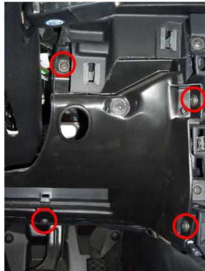
Nun noch einmal an jeder Stelle eine Torx - Schraube entfernen. Nachdem dann alle Schrauben gelöst wurden, kann man die große Verkleidung die unter dem Lenkrad ist abnehmen. Und nun ist es geschafft. Das Steuergerät ist zusehen. Wie man im nächsten Schritt sieht.
