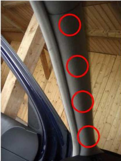
Die Antenne wird in der A-Säule auf der Fahrerseite verlegt. Die Verkleidung der A-Säule ist nur gesteckt. Man sollte sehr vorsichtig die Verkleidung an den vier Punkten lösen um nichts zu beschädigen. Ist das vollbracht sieht es so aus wie in Schritt 10.
