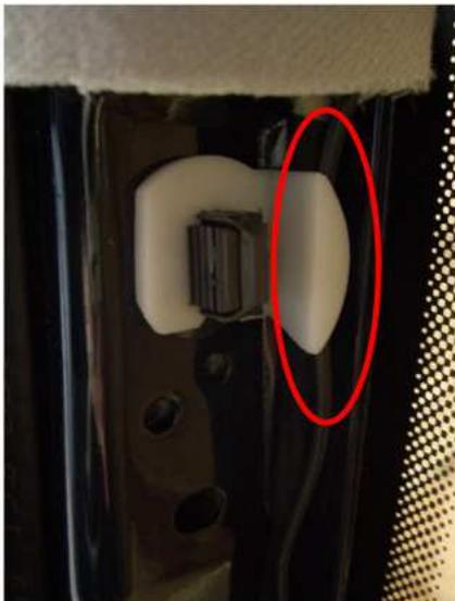
Die Antenne wird ohne den Himmel zu entfernen in den Himmel geschoben und dann hinter den Klemmen an der A-Säule Richtung Steuergerät verlegt. Im Anschluss kann die Verkleidung direkt wieder an die A-Säule.
