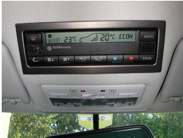
Zieht dann vorsichtig mit dem Messer die Kanten der Blende nach, macht aber den Ausschnitt in der Höhe und Breite ca. 1 mm kleiner als die Dekorblende. Der Himmel ist sehr weich und ohne Probleme mit dem Cuttermesser zu schneiden. Schneidet aber den Himmel nicht in einem Stück durch sondern in 3 oder 4 Schnitten, so könnt ihr auch sauber in die Ecken schneiden.
