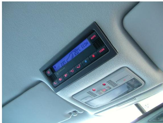
Ihr könnt dann alle unter „Tag 1“ genannten Verkleidungsteile wieder einbauen. Die Verkleidung der A-Säule hat bei mir ohne Probleme über die Leitungen gepasst, sollte es bei euch etwas enger zugehen müsst Ihr evt. die Clipse der Verkleidung bearbeiten.
