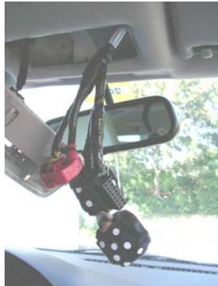
Wenn schließlich alle Leitungen zum Spalt am Dachhimmel verlegt sind, könnt ihr Strang für Strang über die A-Säule, durch das Armaturenbrett runter legen und mit dem entsprechendem orig. Strang verbinden. Macht bitte ab hier nur Strangweise weiter da es sonst ziemlich chaotisch wird wenn Ihr z.B. gleich alles auf einmal nach unten legt. Es ist hinter dem Armaturenbrett genug Platz um alles sauber nach unten zu verlegen.
