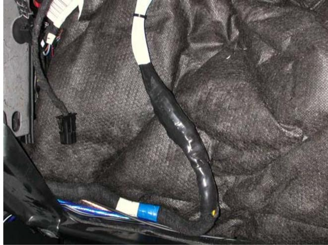
Zusätzlich habe die Leitungen an der Stelle wo sie durch das Armaturenbrett laufen mit einem Spiralschlauch gegen durchscheuern gesichert.
