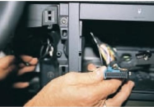
**6** Der Leitungssatz zum Anschluß des Navigationsteils an das Bordnetz wird durch den Radioschacht über die Lenksäule hinweg zum Relais-träger der Zentralelektrik verlegt und mit Kabelbindern so gesichert, daß er weder an scharfen Kanten noch durch die verstellbare Lenksäule beschädigt werden kann
