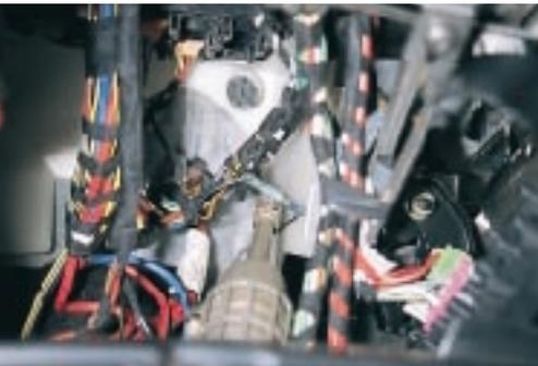
**7** Um Freiraum zum Anschließen der Leitungsenden hinter dem Relais-träger zu schaffen, löst man seine beiden Schrauben und legt ihn zur Seite. Das schwarz/blau Ende wird abisoliert und an die schwarz/blau Leitung vom Rückfahrcheinwerfer mittels Quetsch-Schrumpf-Verbinder angeschlossen
