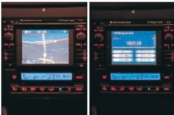
**Auf dem schwenkbaren 5 Zoll-Farbdisplay werden sowohl die Navigationskarte mit Streckenführung als auch die Radio-Infos mit den abgespeicherten Sendern gezeigt**
