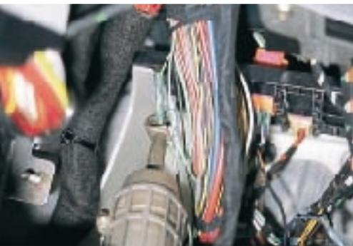
**8** Im dicken Leitungsstrang befinden sich die beiden grün/weiß und grün/gelb gekennzeichneten ABS-Signalleitungen. Auch diese werden freigelegt, getrennt, abisoliert und daran die entsprechend eingefärbten Leitungen zum Navigationsgerät angeschlossen, danach mit dem Heiß-luftföhn eingeschrumpft
