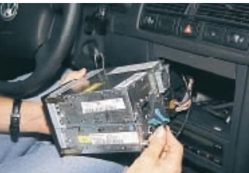
**10** Danach sind nur noch die Versorgungs- und Antennenstecker sowie das Radio-Navigationsgerät einzusetzen und zu kalibrieren. Das geht einfach mit eingelegter CD-ROM im Einstellmenü, während die ABS-Impulszahl 43 und der Radumfang aus der beigegeführten Tabelle ins System eingegeben wird
