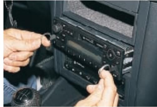
**2** Um Platz für die kompakte Anlage aus Radiogerät mit TIM- und CD-Wechsler-Steuerung einschließlich dem Navigationssystem mit 5-Zoll Farbmonitor zu schaffen, muß das Ablagefach darüber als zusätzlicher Raum genutzt werden. Das läßt sich mit kräftigem Ruck herausziehen
