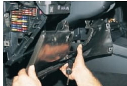
**5** Damit die bereits unter der linken Schwellerverkleidung verlegte GPS-Versorgungsleitung hinter der unteren A-Säulenverkleidung weiter zum Radioeinbauschaft verlegt werden kann, muß zu deren Ausbau erst der Motorhaubenöffner abgenommen werden. Dazu ist dessen vorn befindliche Sperrklinke auszurassten
