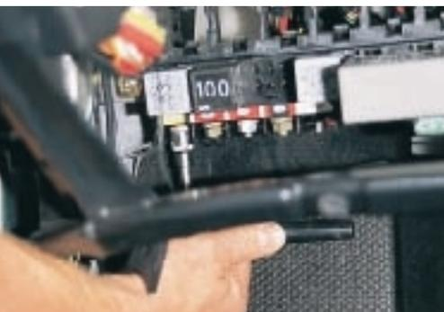
**9** Die Stromversorgung von Klemme 15 geschieht bei wieder angeschraubtem Relais-träger an der Strom-leiste. Dort wird am Anschluß 75X die schwarze Leitung mit ihrer Ringöse angeschlossen und der Sicherungshalter mit Flachsicherung in eine freie Haltenut darüber eingerastet
