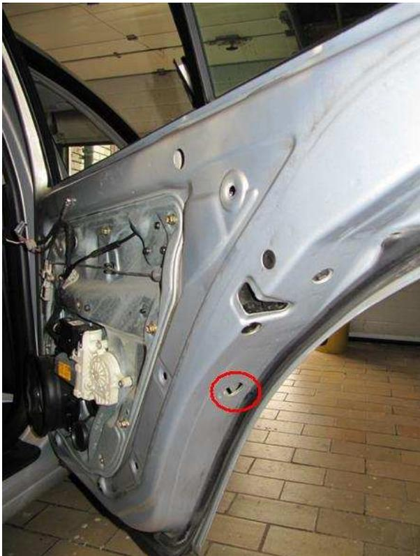
Schiene nach unten ziehen, damit sie oben aus der Halterung geht.
