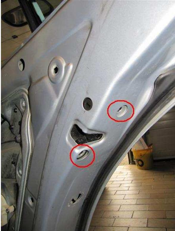
Die Dichtung des Türblechs klebt in der Regel ziemlich fest. Ihr werdet es vor dem Ausbau rundherum mit einem Schraubendreher leicht abhebeln müssen.
