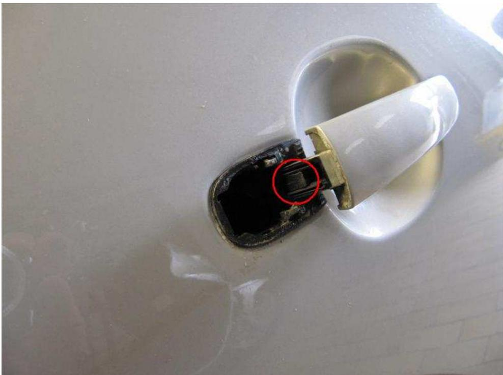
Gummibalg an B-Säule lösen und Steckverbindung zur Tür trennen.
