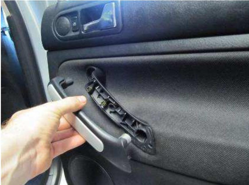
Schrauben der Verkleidung lösen
