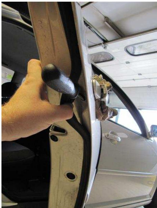
Schraube langsam herausdrehen, dabei immer wieder am Schließzylindergehäuse ziehen, bis es sich entfernen lässt.
