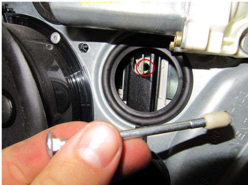
Eine M8 Schraube (ca. 80mm lang) in den großen Nippel einschrauben und rausziehen
