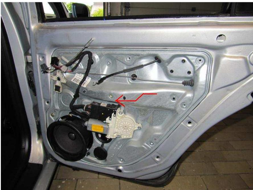
Wenn man das Türblech in der Hand hat, noch die Kabel aus der B-Säule ziehen und den Halter vom Kabelsatz vom Halter in der Tür (roter Kreis) lösen, dann kann man das ganze Türblech mitnehmen.
