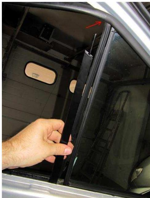
Dann Fensterschiene nach oben aus dem Fensterschacht ziehen!
