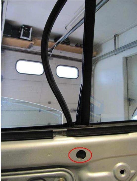
Rastnase des Füllstücks (roter Kreis) leicht anhebeln (Rastnase bricht sehr leicht!).
