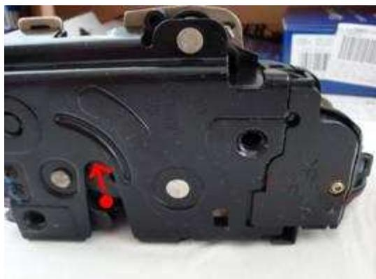
Meistens ist der äußere Mikroschalter total versifft. Am besten mit Bremsenreiniger oder wie ich mit Aceton reinigen und mit Pressluft ausblasen. Das ganze in beiden Stellungen des Mikroschalters.
