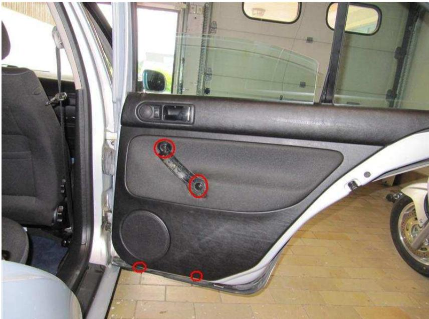
Türverkleidung im unteren Bereich abhebeln. In etwa bei den roten Kreisen ist die Türverkleidung mit Clips befestigt. Wenn die Türpappe unten lose ist, kann sie nach oben aus der Fensterschachtdichtung ausgehoben werden. (Bei mir geht das immer am besten, wenn ich im hinteren Bereich der Türe anfangen und Richtung B-Säule arbeite). Nicht zu weit hochheben, unter der Verkleidung sind noch Kabeln und ein Seil an der Türpappe
